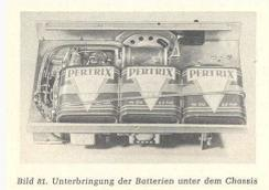
Unterbringung der Batterien unter dem Chassis DJ5MM
