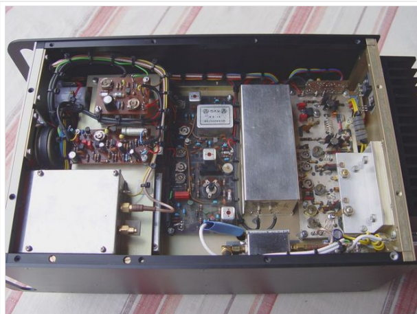
Neukonstruktion des SSB/FM-2m-Transceivers aus SEMCO-Bausteinen
