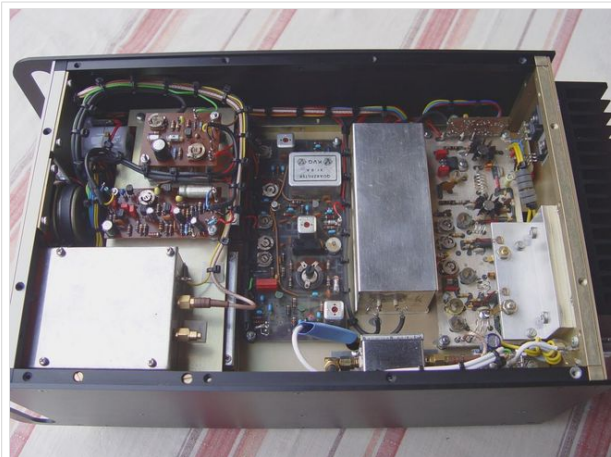
Neukonstruktion des SSB/FM-2m-Transceivers aus SEMCO-Bausteinen
