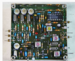
Ursprünglich war der BFO des Empfängers freischwingend - nun mittels Quarzfrequenz erzeugt
