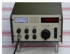
Neukonstruktion DK4SX, mit Umschalter FM/SSB und Relaisablage
