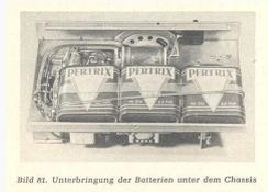
Unterbringung der Batterien unter dem Chassis DJ5MM
