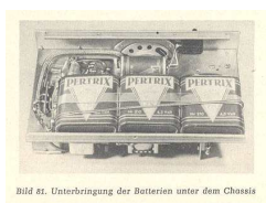
Unterbringung der Batterien unter dem Chassis DJ5MM
