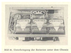
Unterbringung der Batterien unter dem Chassis DJ5MM
