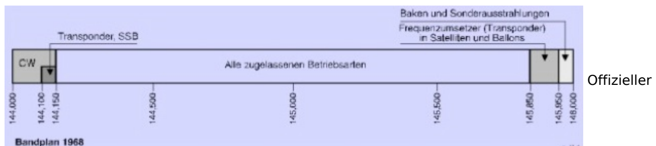
Bandplan für das 2 Meter Band 1968
