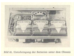
Unterbringung der Batterien unter dem Chassis DJ5MM
