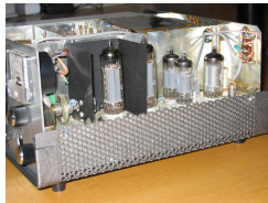
Detailansicht der Endstufe
