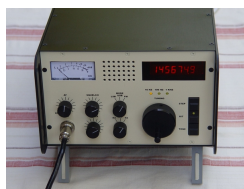
Originales SEMCO- SSB, getrennte FM /SSB Einstellung für TX und RX, BFO- Abstimmung
