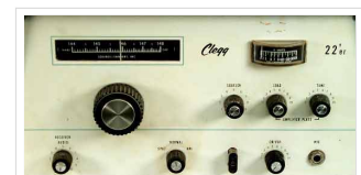
Clegg VHF-AM- Transceiver 22'er
