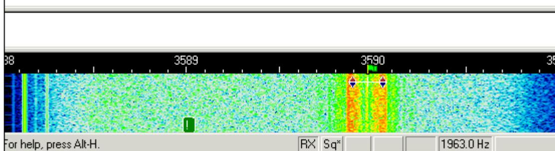
Das Signal sollte grob auf eine NF-Frequenz um 1500 Hz oder die Mitte des Fensters eingestellt werden.
