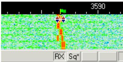
Die TX- und RX-Frequenzen zeigen die Werte aus dem Wasserfall. Ich empfehle Werte um 1500 Hz in der Mitte des Paßbandes.
