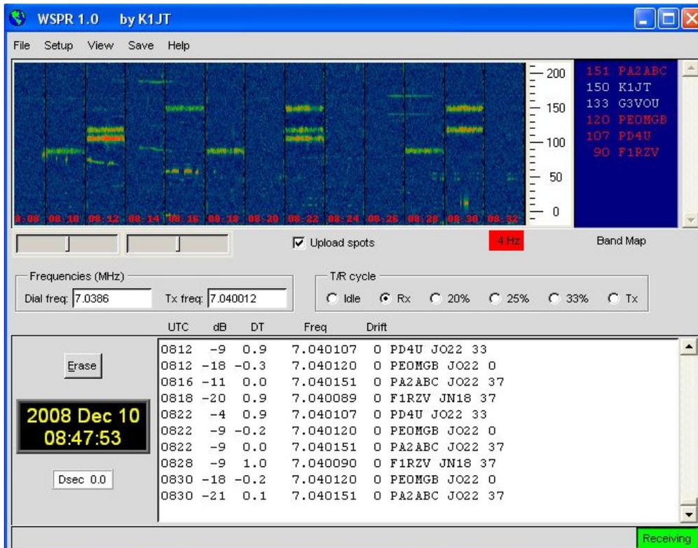
Das Programm WSPR r die Möglichkeiten einer Sound Karte für die Send und Empfangsfunktion WSPR erzeugt und empfängt Signale mitte strukturierter Nachricht und einer leistungsfähig Vorwärts Korrektur basierend auf einer 4-F Modulation. Das Ziel der Entwicklungsanstrengung war es sehr schwache Signale zu decodieren. In der Praxis arbeitet das System gut bis zu Signal Rauschabständen von -2 bei einer Referenzbandbreite von 2500Hz.
