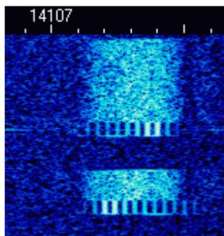
Beispiel eines Packet-Signals mit 300 Baud
