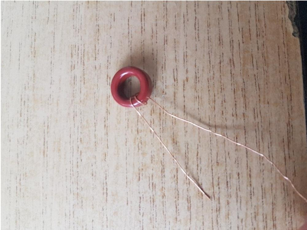
So schauen dann die ersten beiden Wicklungen aus. Ca. 5cm freilassen und dann entgegen den Uhrzeigersinn wickeln. Immer straff festziehen (aber natürlich mit Gefühl und ohne Werkzeug !)
