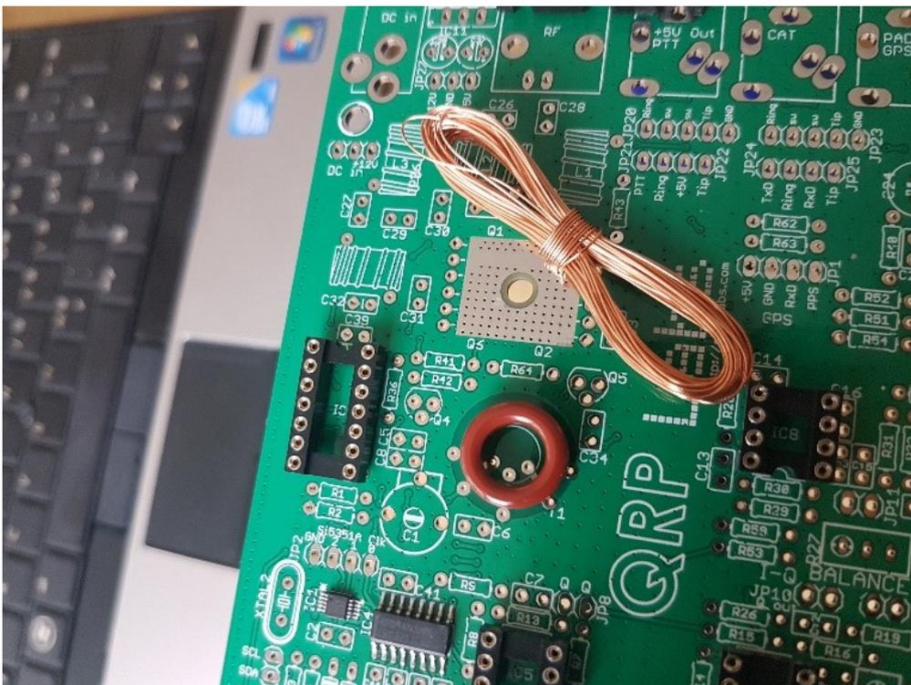
Zuerst wickelt man ganz langsam den CU Draht ab. Daher muss man darauf achten, dass der Draht keine Schlingen macht. Immer gleich straff gerade ausrichten. Sonst entstehen kleine Knoten und der Draht kann brechen.
