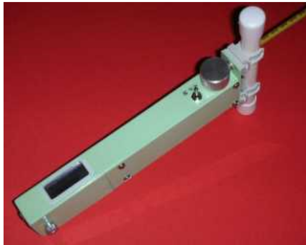
Peilempfänger mit Ferritantenne
