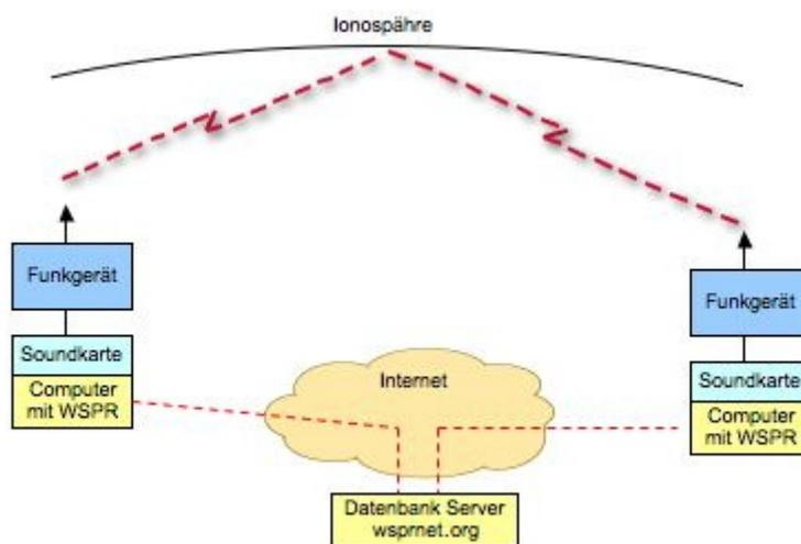
Mit Sendeleistungen von 200mW können die Baken weltweit empfangen werden.
