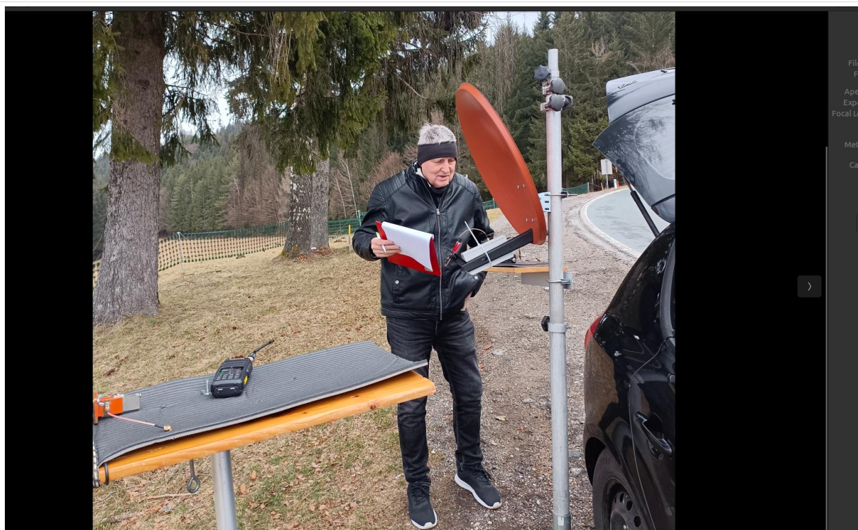
8 Jahre El Cuatro: OE8FNK beim Aktivitätskontest am 18.2.2024, QRV auf 70cm (Handfunkgerät links), und El Cuatro mit Vivaldi Antenne im Feed des Offsetspiegels für 23cm, 13cm, 9cm und 6cm.
