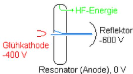
Das Klystron wurde 1937 an der Stanford University in Kalifornien von den Brüdern Varian und W. Webster entwickelt. Das Reflexklystron ist eine Laufzeitröhre, Elektronen die von einer Glühkathode ausgesendet und von der Anode beschleunigt werden, durchlaufen die Resonator-kammer und erzeugen ein elektro-magnetisches Feld. Nach einer gewissen Laufzeit werden sie vom negativen elektrischen Potential des Reflektors zur Umkehr
