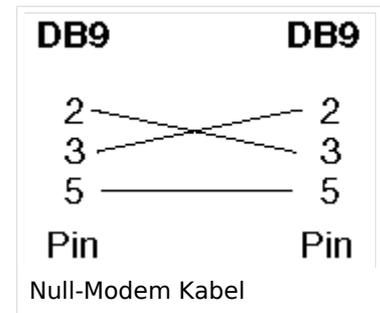
Nun lädt man den Client, unter Windows am Besten das freie Programm "Putty" (einach Google bemühen), und startet es im seriellen Modus mit 115200 Baud. Wenn das Routerboard und der PC über das Null-Modem Kabel verbunden sind, kann man am Routerboard die Spannung anlegen.
