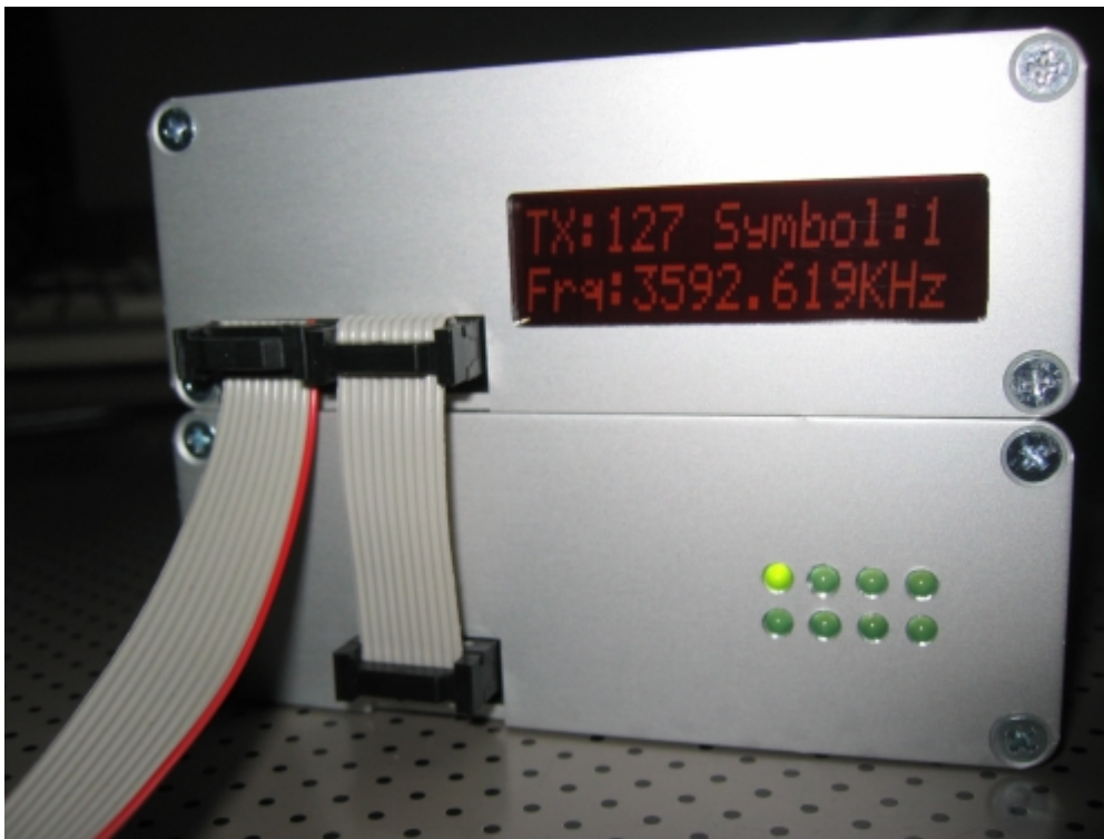
MEPT switch module
