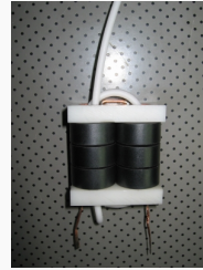
OE1IFM Aufbau Transformator
