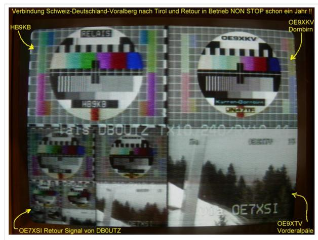
Wir senden auf 10.450 GHz Vertikal mit jeweils 600mW Richtung Bodensee und Ulm, mit 1.2 Watt jeweils Richtung östlich von Augsburg und OE7XLT.
