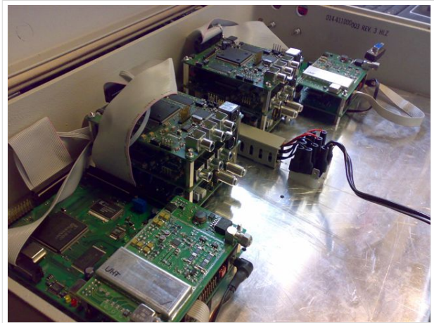
Der neu aufgebaute Digitale Linksender
