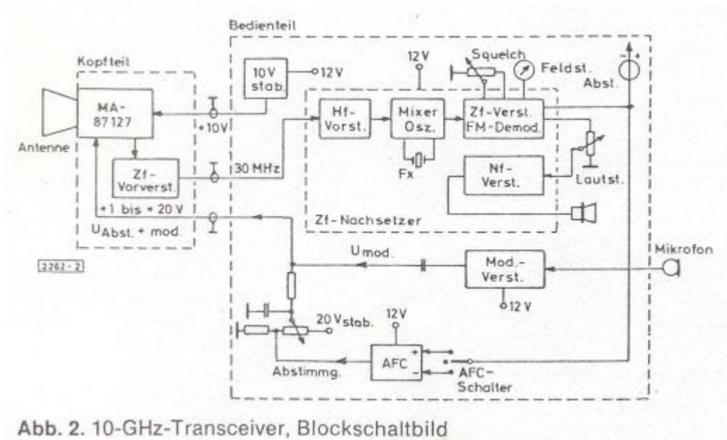
Abb. 2. 10-GHz-Transceiver, Blockschaltbild
