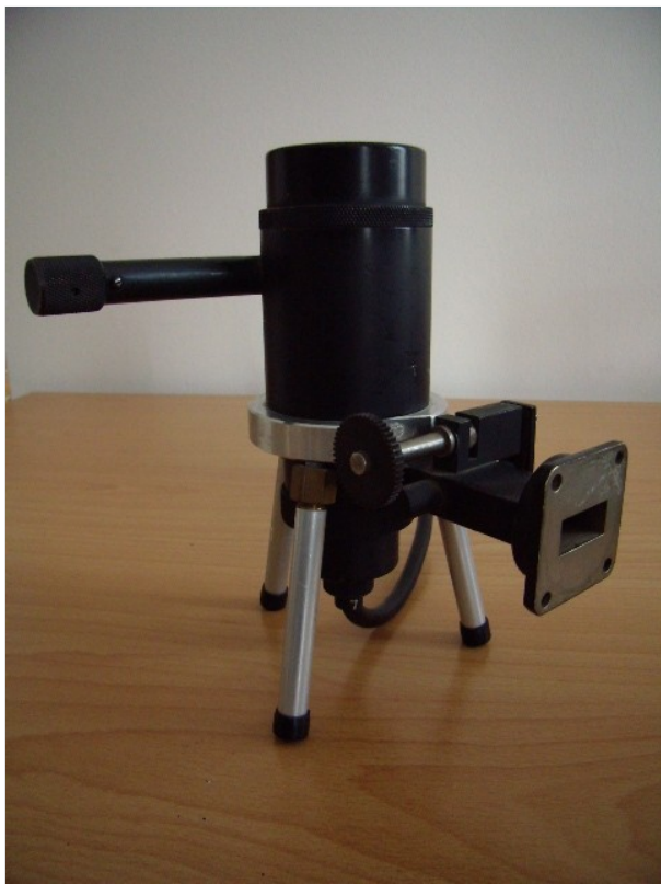
9GHz Klystron mit WR90 HL-Ausgang
