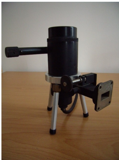
9GHz Klystron mit WR90 HL-Ausgang
