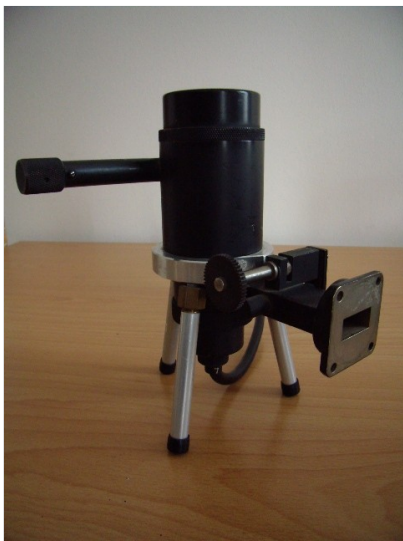
9GHz Klystron mit WR90 HL-Ausgang
