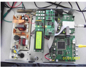
70cm ATV-Empfänger - Feldversuch im April 2010
