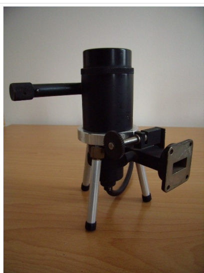
9GHz Klystron mit WR90 HL-Ausgang
