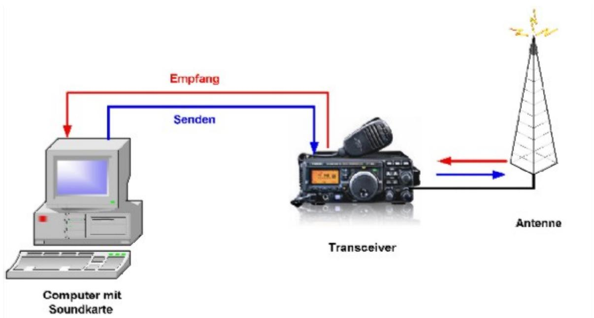
Die obige Zeichnung zeigt die Konfiguration und den Signalverlauf bei Verwendung der Soundkarte als Modem. Die empfangenen Signale von der Antenne werden im Transceiver demoduliert und in hörbare Töne umgewandelt. Diese werden (zumeist aus dem Lautsprecherausgang) dem Eingang der Soundkarte (Line-In oder Mic-In) zugeführt. Die Software im PC wandelt nun diese Töne entsprechend der gewählten Betriebsart in die Zeichen um und stellt diese am Bildschirm dar.
