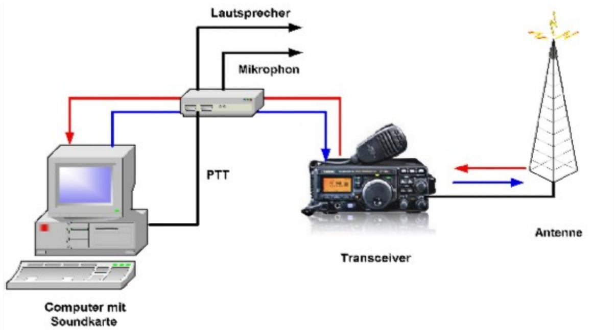
Diese werden zwischen Computer (Soundkarte) und Transceiver geschaltet und bieten Umschaltmöglichkeiten zwischen Voice-Betrieb und Digi-Mode, Mithören ein/aus, usw. Da beim Senden der Transceiver ja idealerweise vom PC aus getastet wird, bieten diese Interfaces zumeist auch eine oder mehrere Möglichkeiten, die PTT zu bedienen. (Es ist zwar möglich, die PTT direkt von Hand zu bedienen, aber das ist auf Dauer zu mühsam und daher nur zu ersten Testzwecken empfehlenswert)
