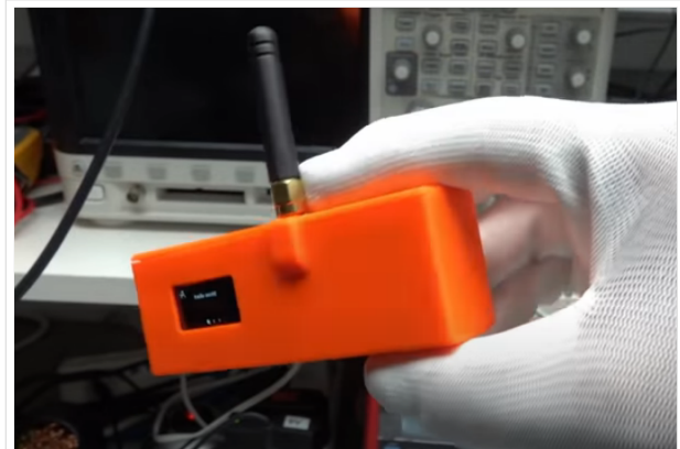
TBEAM im 3D-gedrucktem Gehäuse
