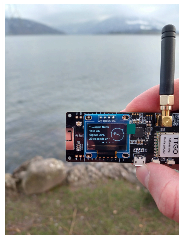
TBEAM Lora mit OLED-Display
