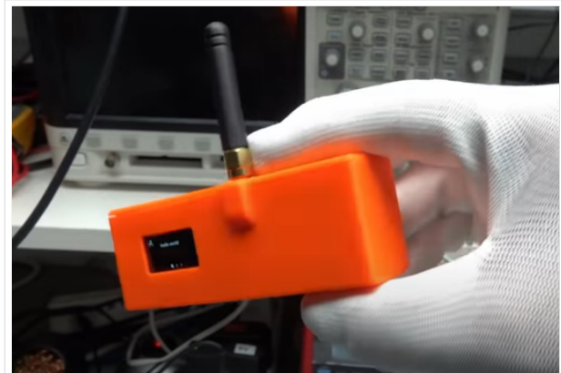
TBEAM im 3D-gedrucktem Gehäuse
