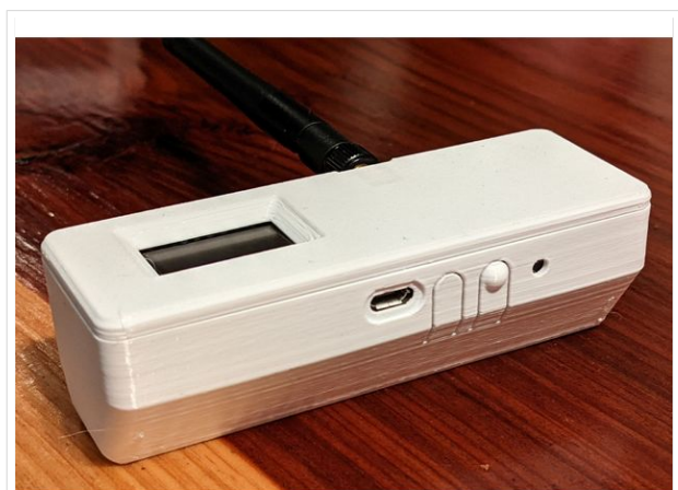
TBEAM Gehäuse mit Tasten und OLED
