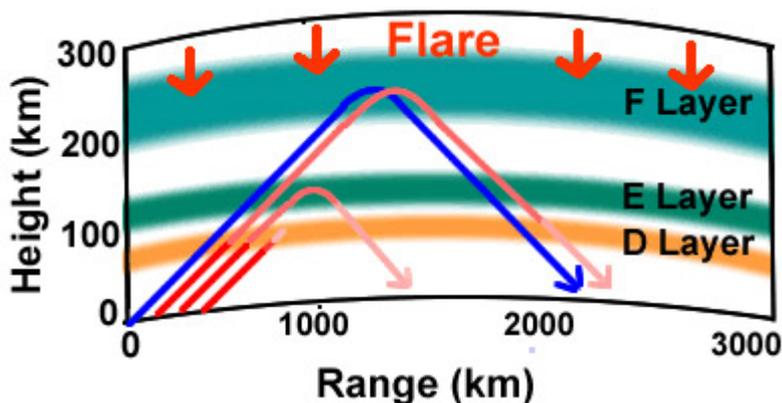
Die minimale Stationsausrüstung auf 2m besteht in einem Transceiver mit 2 Watt Ausgangsleistung und einem Rundstrahler. Eine bessere Stationsausrüstung erhöht natürlich die Erfolgsquote. Die überbrückbare Entfernung bei ES liegt zwischen 1200 und 2200 km. Bei den auf 2m relativ seltenen Doppelsprüngen können auch 3500km erreicht werden. Die Zeitschrift Dubus (Nr 4/94) berichtete sogar von einer 2m-Verbindung von OE1SSB & OE1XLU mit RI8TA über 4271km am 21.Juli 89.
