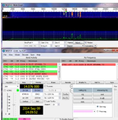
WSJT-X implementiert Kommunikationsprotokolle oder "Modi" namens FST4, FST4W, FT4, FT8, JT4, JT9, JT65, Q65, MSK144 und WSPR sowie eines namens Echo zum Erkennen und Messen Ihrer eigenen vom Mond reflektierten Funksignale. Diese Modi wurden entwickelt, um zuverlässige, bestätigte QSOs unter extrem schwachen Signalbedingungen zu machen.
