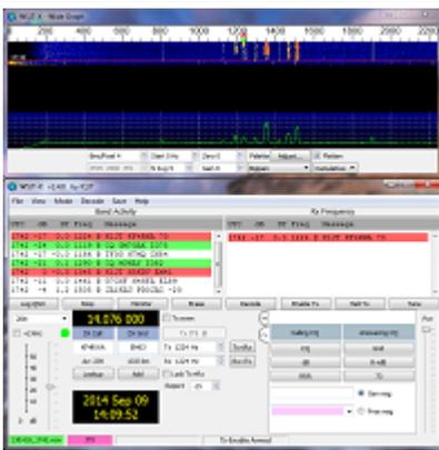
WSJT-X implementiert Kommunikationsprotokolle oder "Modi" namens FST4, FST4W, FT4, FT8, JT4, JT9, JT65, Q65, MSK144 und WSPR sowie eines namens Echo zum Erkennen und Messen Ihrer eigenen vom Mond reflektierten Funksignale. Diese Modi wurden entwickelt, um zuverlässige, bestätigte QSOs unter extrem schwachen Signalbedingungen zu machen.
