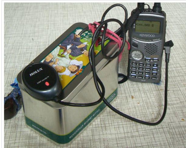
Erste Versuche mit GPS Maus und Blechdose zum Verstauen von Allem und "hightech" Magnethalterung
