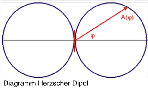
Um nun zu wissen, welches der beiden Signale wirklich zum Sender zeigt, wird das elektrische Signal herangezogen. Mit einer Stabantenne wird das elektrische Signal empfangen. Mischt man nun das elektrische und das magnetische Signal zu gleichen Teilen zusammen, haben wir durch die zwischen magnetischem und elektrischem Signal bestehende Phasenverschiebung eine Addition, beziehungsweise eine Subtraktion der beiden
