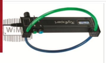
Peilempfänger mit Rahmenantenne
