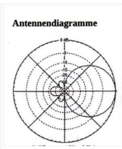
Die Antennen weisen eine keulenförmige Charakteristik auf, die zum Sender gerichtet am meisten Signal liefert. In entgegen gesetzter Richtung wird das Signal stark gedämpft. Es wird also auf maximales Signal gepeilt.
