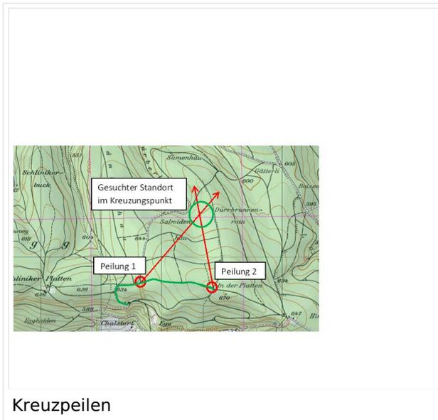
Bei Wettkämpfen wird diese Methode nur noch angewendet bei sehr schwierigem Gelände, z. B. um heraus zu finden, ob sich ein Sender vor oder nach einem Bach, Tobel oder Hügel befindet.
