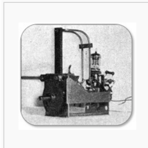
Wallmann Konverter: Oszillator
