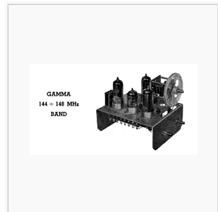
Der VFO schwingt um 18MHz und wird auf 144 vervielfacht, um im gesamten Band rufen zu können. Der 12MHz Quarzosz. dient dann dem "stabilen" QSO
