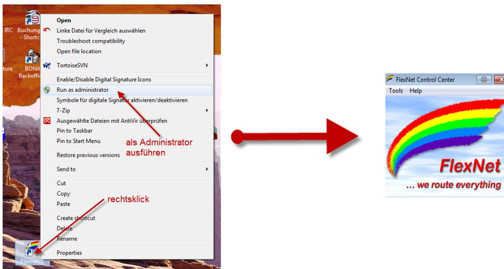
Rechtsklick auf die erstellte Verknüpfung oder flexctl.exe ---> Als Administrator ausführen. Damit Flexnet ordentlich auf die Hardware zugreifen kann muss dieses als Administrator laufen, alternativ kann man auch die „Benutzerkontensteuerung“ unter Windows 7 ganz nach unten drehen.
