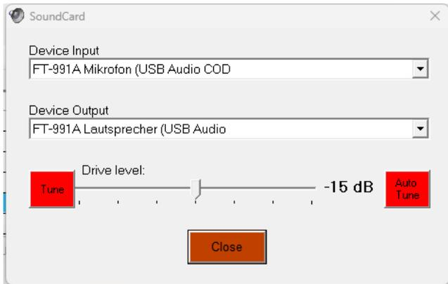
Den "Drive level" = Ausgangssignal der Soundkarte stelle ich für den Start in die Mitte.
