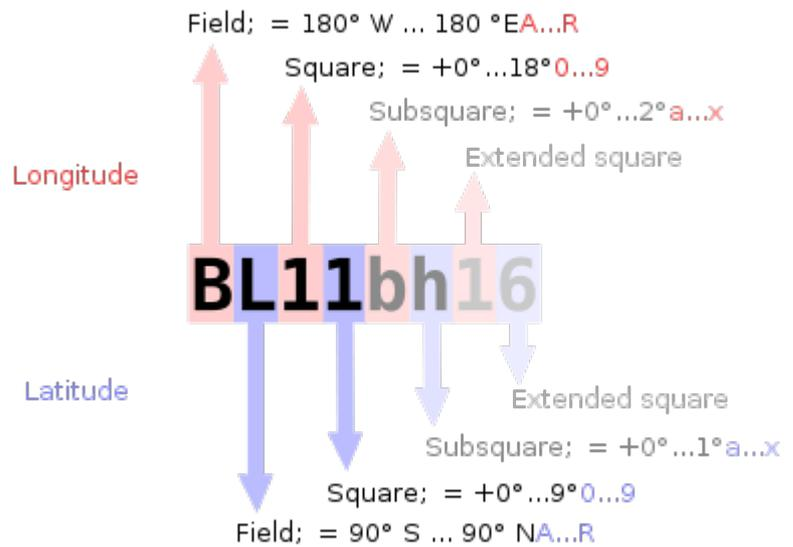
Um negative Zahlen bei den Daten zu vermeiden wurde das System so spezifiziert das die Breite vom Süd zum Nordpole und die Länge ostwärts vom Greenwich Längengrad gemessen wird vom Anfangsmeridian ein "falsches Ost" von 180 Grad und dem Äquator ein falsches Nord von 90 Grad verliehen.
