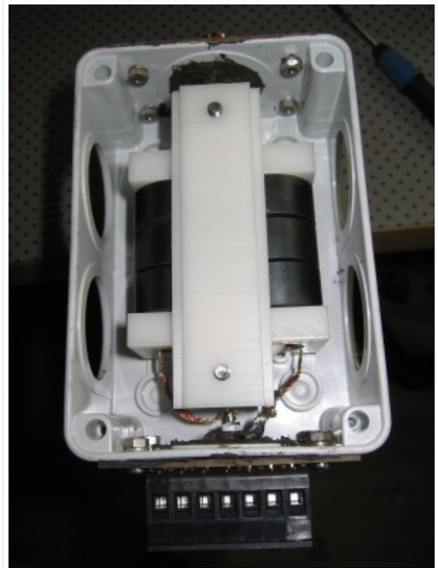
Transformator im Gehäuse
