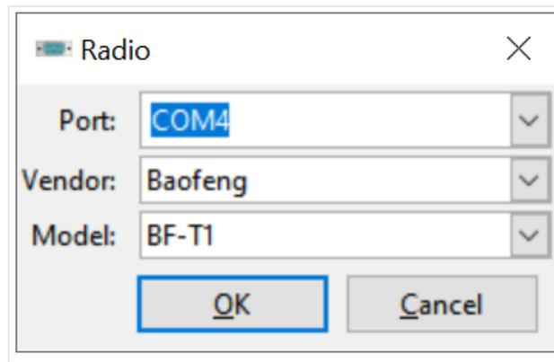
Der Port ist je nach Windows-Konfiguration unterschiedlich, ggf. im Windows-Gerätemanager nachsehen oder die angebotenen Ports durchprobieren. Die Verbindung ist nicht besonders robust, ggf. Gerät ausschalten, Kabel neu anstecken und vor der Datenübertragung einschalten.
