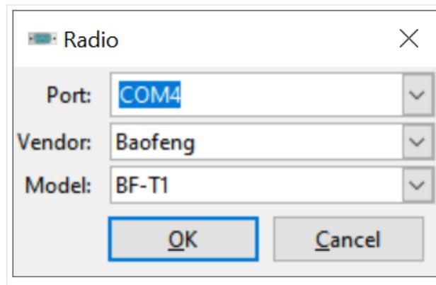
Der Port ist je nach Windows-Konfiguration unterschiedlich, ggf. im Windows-Gerätmanager nachsehen oder die angebotenen Ports durchprobieren. Die Verbindung ist nicht besonders robust, ggf. Gerät ausschalten, Kabel neu anstecken und vor der Datenübertragung einschalten.
